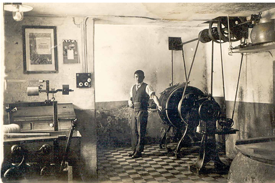
Innenraum der Sennerei um 1940 mit Matthäus Schöch, Transmission mit Butterfass, rechts der Käsekessel, links die Milchwaage
