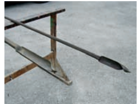
zwei Deuchelbohrer zur Herstellung von Holzrohren
